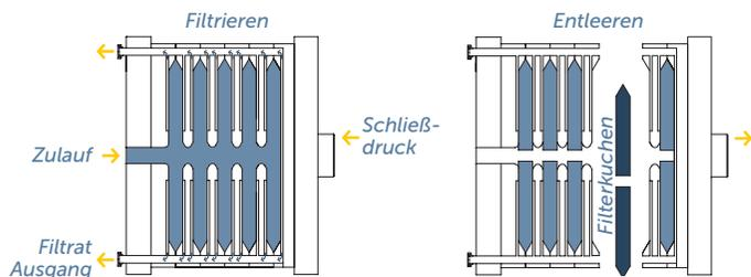
Kammerplatte Clean-System und Filtertuch mit integrierter Randabdichtung (patentiert)
